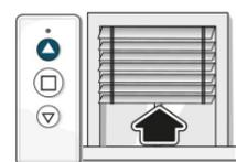
c) Appuyer sur le bouton Montée et laisser le BSO s'arrêter de lui-même
