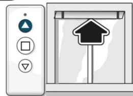
b) Appuyer sur le bouton Montée et laisser le BSO s'arrêter de lui-même
