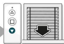
a) Appuyer sur le bouton Descente et stopper le BSO à la position basse désirée
