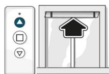
b) Appuyer sur le bouton Montée et laisser le BSO s'arrêter de lui-même
