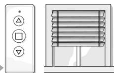
a) Positionner le BSO à mi-hauteur à l'aide de la télécommande
