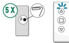
b) A l'aide d'un trombone, appuyer 5 fois sur F, au dos de la télécommande et vérifier lors de chaque appui que le voyant s'allume
