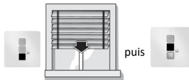
a) Appuyer sur le bouton **Descente** et **Stopper** le BSO à la position désirée.
