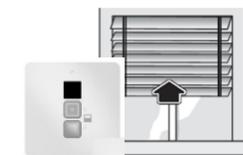
d) Appuyer sur le bouton **Montée** et laisser le BSO s'arrêter de lui-même.
