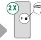
A l'aide d'un trombone, appuyer 2 fois sur F puis en même temps appuyer sur les boutons MONTEE et STOP
