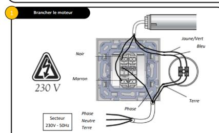
Branchement à réaliser dans le respect de la norme NF C 15-100
