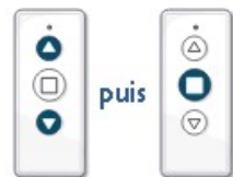
a/ Prendre la télécommande de l'Équipement à ajouter. Appuyer en même temps sur les boutons Montée et Descente puis sur le bouton Stop.
