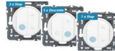
c) Faire **3 appuis** sur le bouton **Stop** puis **3 appuis** sur le bouton **Montée** puis **1 appui** sur le bouton **Stop**.
