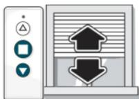
a) Appuyer en même temps sur le bouton Descente et Stop, et laisser le volet s'arrêter de lui même
