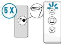
b) A l'aide d'un trombone, appuyer 5 fois sur F, au dos de la télécommande et vérifier lors de chaque appui que le voyant s'allume
