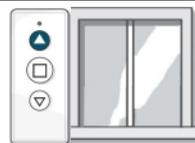
b) Appuyer sur le bouton Montée et laisser le volet s'arrêter de lui-même
