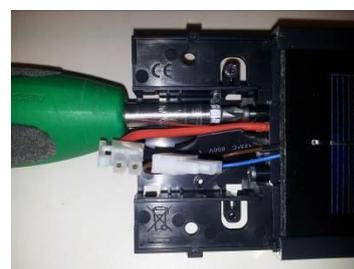
11) Positionner la carte électronique : les fils doivent être placés dessous.
