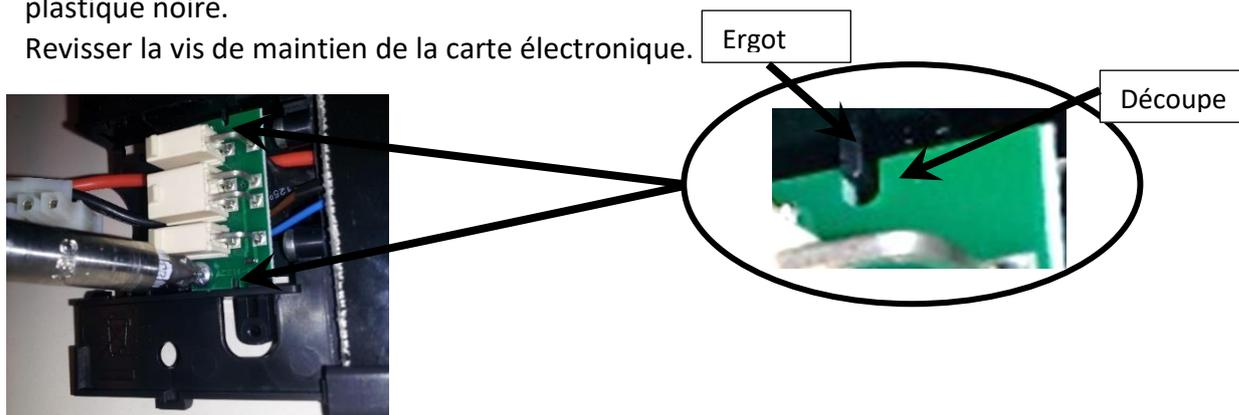
12) Rebrancher les connecteurs de la batterie et du panneau solaire :
