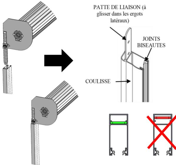
NB : en coulisses **C63**, vérifier le sens d'enroulement du tablier pour positionner les coulisses dans le bon sens
