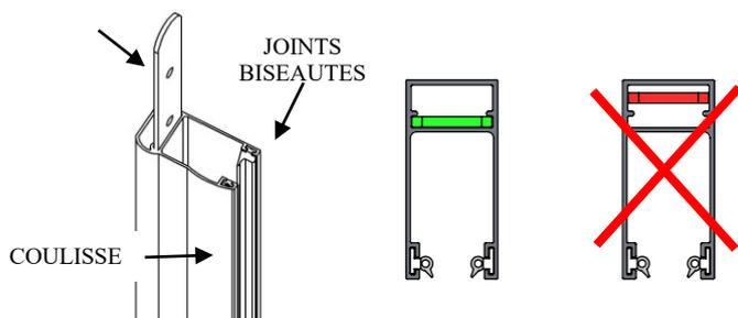
NB : vérifier le sens d'enroulement du tablier pour positionner les coulisses dans le bon sens
