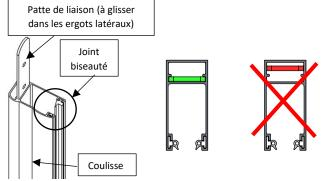
NB: en coulisses C63, vérifier le sens d'enroulement du tablier pour positionner les coulisses dans le bon sens.
