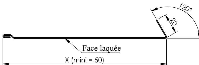
⚠ Profiler à l'envers d'une tôle C
