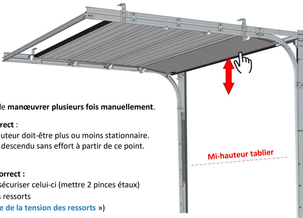
Ouvrir doucement le tablier et le **manœuvrer plusieurs fois manuellement**.
