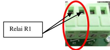
Nota : Le bornier relai R2 sert à brancher un autre automatisme ou au contact sec de l'ouverture piéton.
