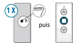
a/ Prendre la télécommande d'un Equipement de l'installation. A l'aide d'un tournevis, appuyer 1 fois sur R puis appuyer sur le bouton Stop
