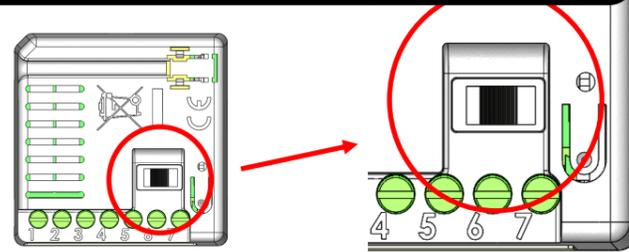
A l'aide d'un tournevis, positionner le commutateur au milieu
