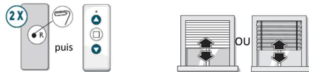
Prendre la télécommande d'un Equipement de l'installation. A l'aide d'un trombone, appuyer **2 fois sur R**, relâcher puis appuyer en même temps sur les boutons **Montée** et **Descente**
