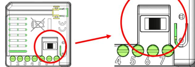
A l'aide d'un tournevis, positionner le commutateur au milieu
