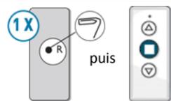
a/ Prendre la télécommande d'un Equipement de l'installation. A l'aide d'un trombone, appuyer 1 fois sur R puis appuyer sur le bouton Stop
