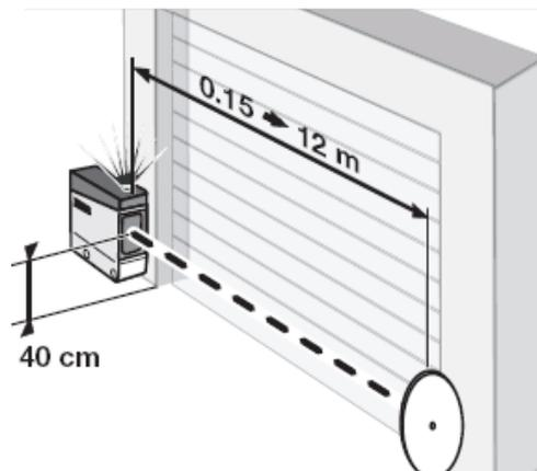
Nota : Si le voyant orange sur la cellule ne s'allume pas tourner la vis « Dist » dans le sens des aiguilles d'une montre jusqu'à ce que le voyant orange s'allume.
